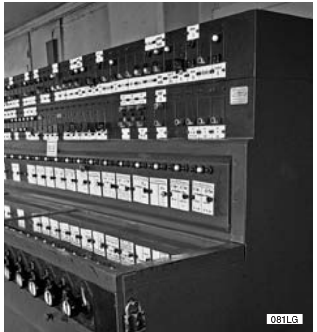
Bild 3.3-1 Elektromechanisches Hebelwerk mit Hebelwerksaufbau
