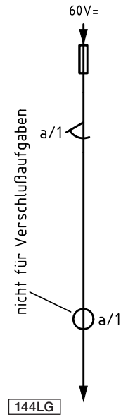
Bild 6.1-3a Fahrstraßensteller (Kleinrelais od. ggf. Normalrelais)
