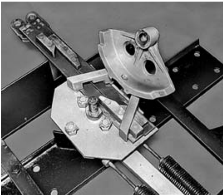
Bild 2.17 Zungenprüfer (Einzelteile; Sperrbogen abgeklappt)
