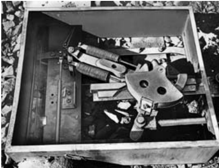
Bild 2.16 Zungenprüfer im Weichenantrieb
